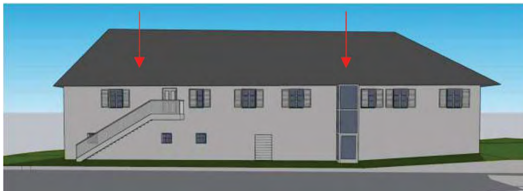
SLIKA 6: NOVO STANJE - SEVERNA FASADA Z ZUNANJIM STOPNIŠČEM IN INVALIDSKIM DVIGALOM
